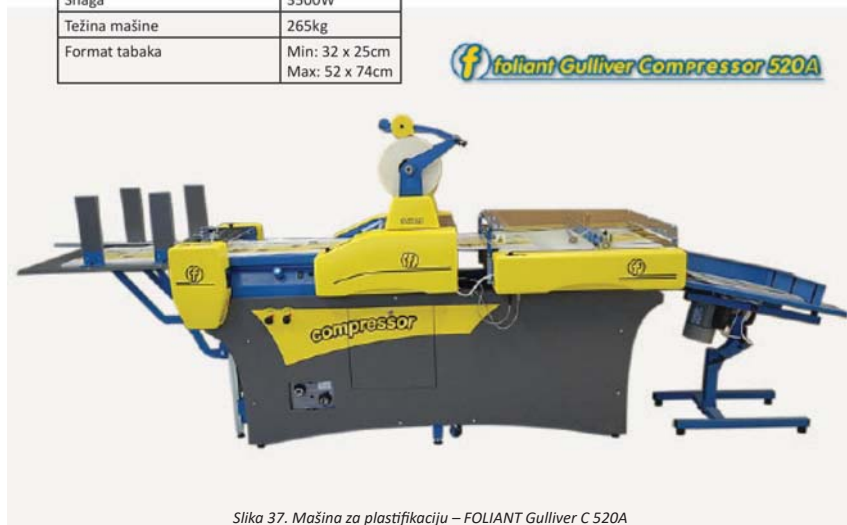
Slika 37. Mašina za plastifikaciju – FOLIANT Gulliver C 520A
