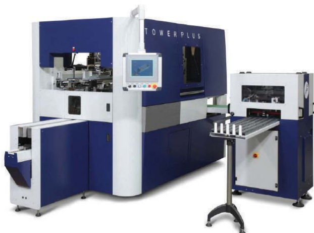
Slika 35. Mašina za spajanje knjižnog bloka sa koricama TECHNOGRAF Tower Plus
