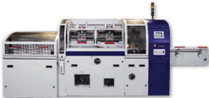
slika 32. Mašina za lepljenje predlista SIGLOCH Endpapering Machine VAM-70
