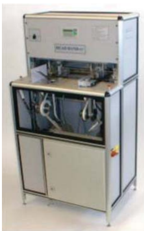
Slika 33. Mašina za lepljenje ukrasne trake Mekatronics HEADBAND-IT
