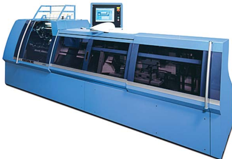
Slika 29. Mašina za šivenje – Muller Martini Ventura MC
